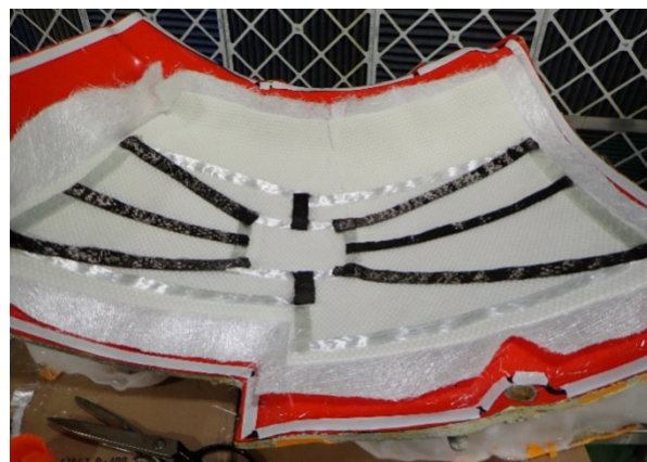
Préforme partielle mixte verre carbone localisé avant infusion
